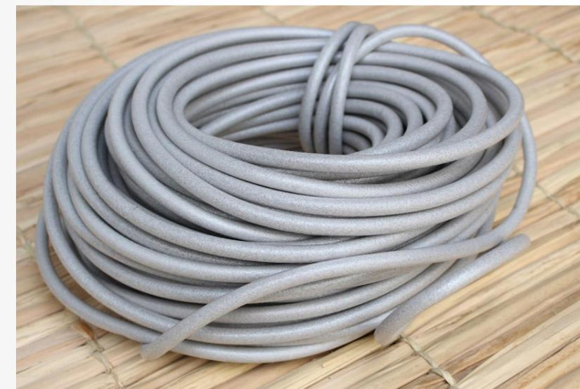
Tarugo de polietileno, flexível em diferentes diâmetros, utilizado como corpo de apoio, limitador de profundidade e vedações. Indicado para juntas de dilatação e separação de divisórias e esquadrias. Facilitando e dando mais firmeza ao acabamento.
